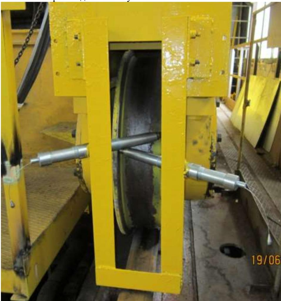
Оборудование универсальной системы смазки реборд колес и боковых поверхностей рельс подъемно-транспортного оборудования, способно минимизировать износ при
