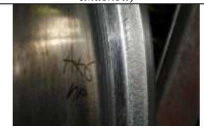
Состояние реборды колеса через полтора года после установки систем смазки (поверхность загладилась до металлического блеска, присутствует постоянный слой смазки)
