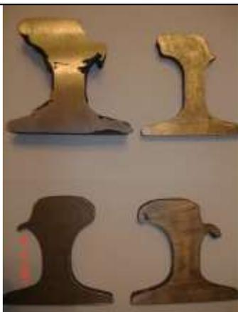
Срезы деформированных рельсов до установки смазывающих устройств ГРС и стержней КС, срок эксплуатации 3 года
