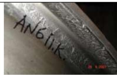
Состояние реборды колеса через четыре месяца после установки систем смазки (выравнивание поверхности)
