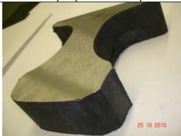
Срезы деформированных рельсов после установки смазывающих устройств ГРС и стержней КС и их эксплуатации в течение 5ти лет
